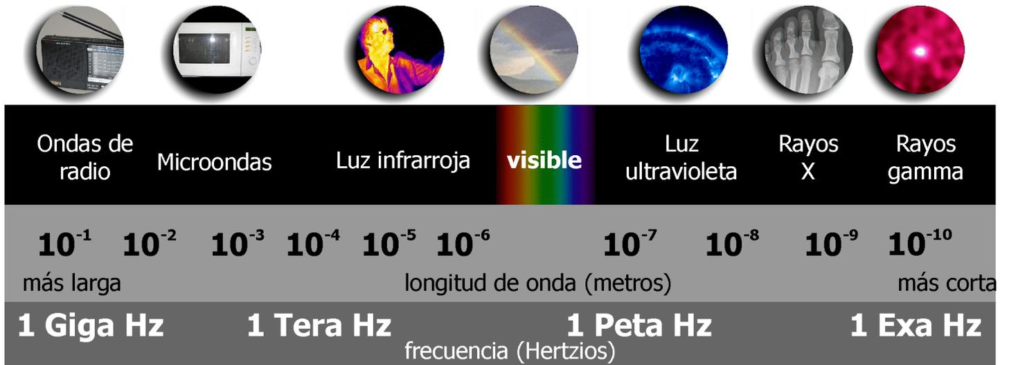
ILUSTRACIÓN 1. ESPECTRO ELECTROMAGNÉTICO
