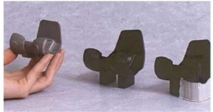
**Figura 3. Piezas plásticas (polimérica) fabricada mediante estereografía 3D**
